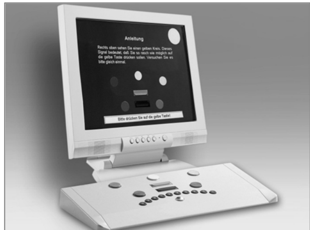
Abbildung 6: Bildschirmpräsentation des Reaktionstests; sichtbar ist die Tastatur mit den Farbtasten (groß; hier Graustufen) für den Reaktionstest und mit den Zahlentasten von 1 bis 9 und 0 in aufsteigender Reihenfolge (klein, schwarz) für den Rechentest
